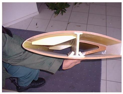
Bei einem Bruchversuch mit diesem Bauteil ergab sich ein ähnlicher Bruchverlauf. Nach dem ausbeulen nach oben schält sich in letzter Konsequenz die Nasenschale von der Holmverklebung ab. Bei diesem Modell sind wie bei der Fascination keine Klebewinkel die Holm und Nasenschale verbinden.
