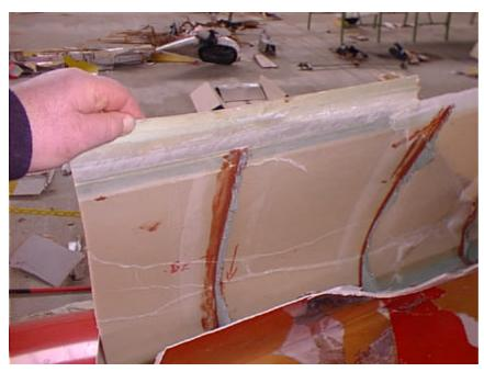
Dies bedeutet, dass die Verklebung über den ganzen Flügel genug Klebekraft besaß, denn diese Verklebung wurde bei der Herstellung in einem Arbeitsgang durchgeführt.
